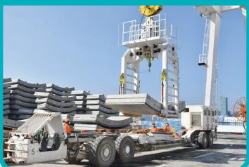
運送預製組件的多用途工程車, 穿梭於物料存放區及隧道 鑽挖機之間
